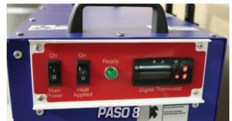
Ahora todo está listo para encender la maquina y el ventilador. Hay que mantener la maquina encendida hasta que la temperatura alcance 140 grados y hay que mantener esa temperatura por 3 horas. Después de este proceso, apague los espirales calefactores y deje que el ventilador quede puesto por 15 minutos. Finalmente apague el ventilador y guarde todo el equipo. **No Cambie El Termostato O La Garantía Será Invalido.**
